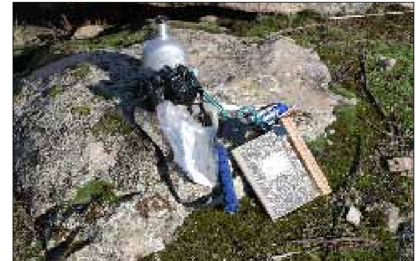
Fig. 1.6. Útiles de campo en geología: martillo, brújula, cuaderno de campo, cámara de fotos, metro, cantimplora, lápices y bolsas de muestras.
