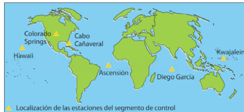
Fig. 1.18. Segmento de control del GPS.
